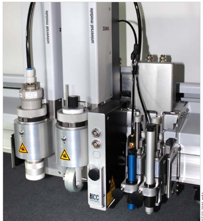
Plně obsazená modulová základna se dvěma UM, ICC kamerou a MAM-D.
