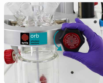
Jednoduché zvedání pohonu míchadla
